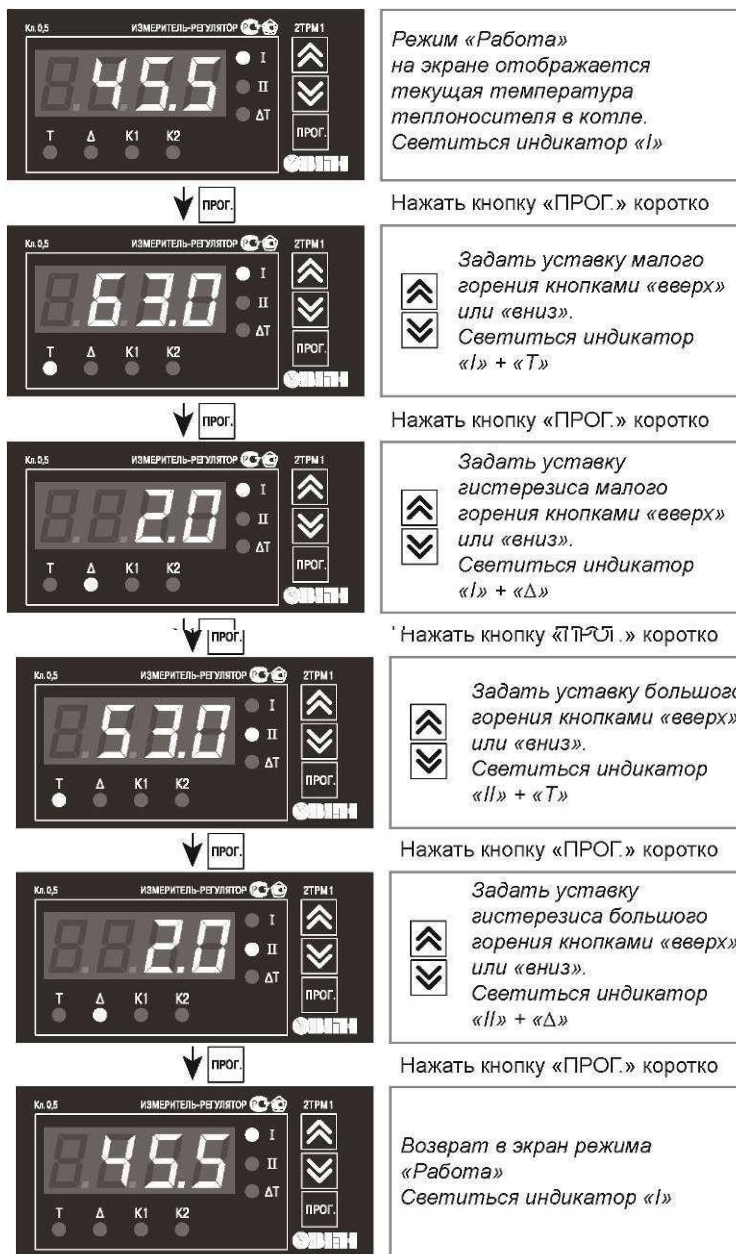
Рисунок 22. Изменение уставок малого и большого горения котла
